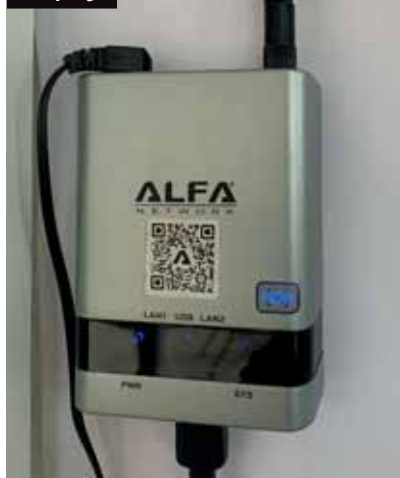
Alfa Wifi-Camp Pro2v2 router, maakt verbinding met het netwerk van de camping.
